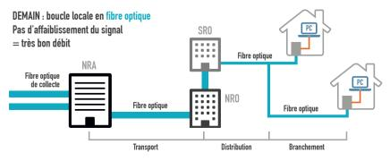
NRA = Nœud de Raccordement d'Abonnés NRO = Nœud de Raccordement Optique SR = Sous Répartiteur
